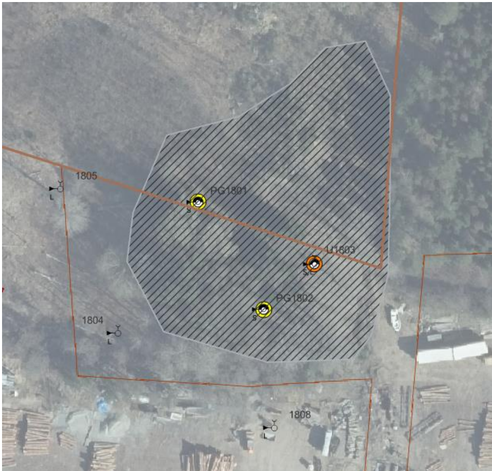
Figur 6 Provpunkter jord och grundvatten Gamla deponin, med föroreningsklassning (jord). Gul >KM, Orange >MKM. (VOS 2018)
